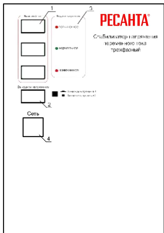
На передней панели шкафа расположены контрольные приборы (1 - амперметры, 2 – вольтметр), позволяющие судить о состоянии стабилизатора, контролировать фазный ток по каждой фазе и линейное напряжение с помощью переключателя, имеется индикация повышенного / нормального / пониженного напряжения (3).
