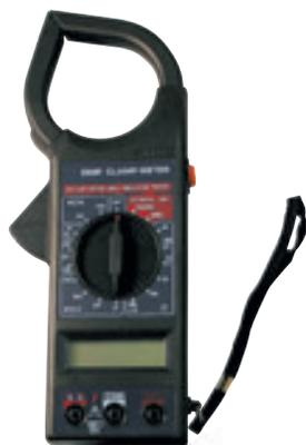
Устройство является измерительным прибором типа “токовые клещи” с возможностью измерения величины изоляции (при наличии 500 - вольтового измерителя изоляции).
